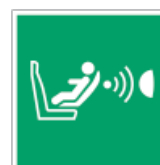
ISO 7010 [E014] Erkennungs- system für das Vorhandensein und die Orien- tierung eines Kindersitzes
