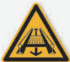
[D-W029] DIN 4844 Warnung vor Förderanlagen am Gleis
