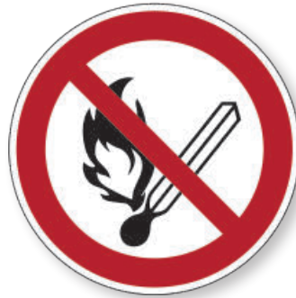
ASR A1.3/ISO 7010 [P003] Keine offene Flamme, Feuer, offene Zündquelle und Rauchen verboten
