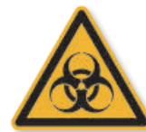
ASR A1.3/ISO 7010 [W009] Warnung vor Biogefährdung
