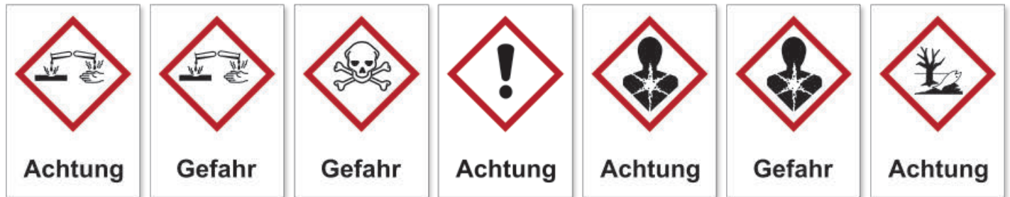
GHS 05 – Achtung Ätzwirkung GHS 05 – Gefahr Ätzwirkung GHS 06 – Gefahr Totenkopf mit gekreuzten Knochen GHS 07 – Achtung Ausrufezeichen GHS 08 – Achtung Gesundheitsgefahr GHS 08 – Gefahr Gesundheitsgefahr GHS 09 – Achtung Umwelt
